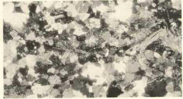
2 Dünnschliffbild eines Gesteins im Reaktionsgleichgewicht (Die Körner ungefähr gleich groß, Winkel zwischen drei Körnern ca 120^\circ )
