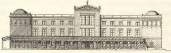
5 Berlin, Museumsinsel. Neues Museum von F. A. Stüler 1841-65, teilzerstört 1943. Hauptfassade, schraffiert die 1989 fehlenden Bauwerksteile: Zumeist unvermeidliche Kriegsfolge, teils auch bedauerliche denkmalpflegerische Rekonstruktions- statt Konservierungsintention und bequemere Baustellenabwicklung
