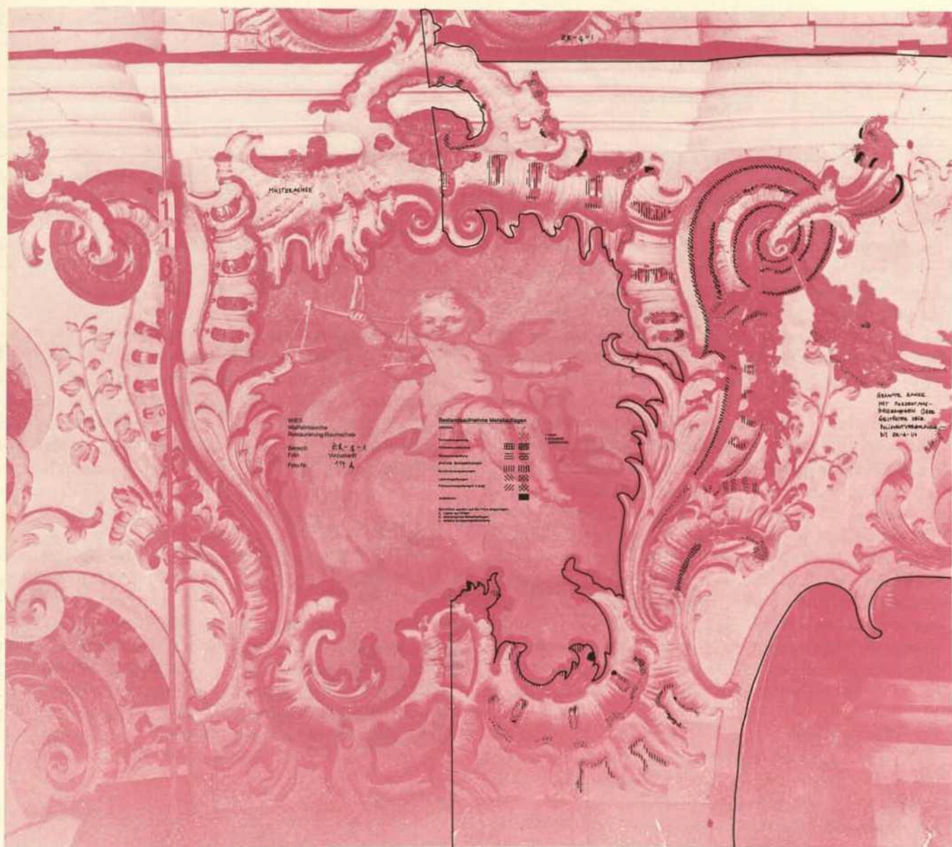
Abb. 6. Beispiel für die zeichnerische Dokumentation der Bestandsaufnahme Metallauflagen im Raumsegment ZR-q, Höhenlage II (Ausführung durch Häfner/Oehmig); Grundlage ist eines der beiden Negative der photogrammetrischen Aufnahme dieses Bereiches; die Legende abgedruckt im Beitrag Häfner/Oehmig, S. 237
