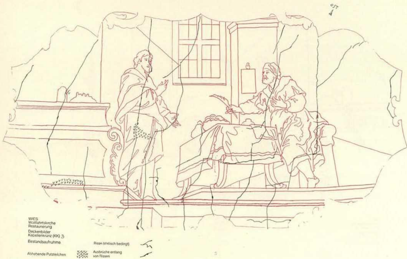
Abb. 40, 41. Dokumentationsfolien «Abhebende Putzteilechen, Risse samt Ausbrüchen» bzw. «Lattung und Kittung» (schwarz) über der Schemazeichnung wie Abb. 38 (rot)
