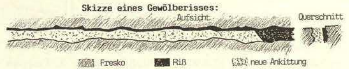
Abb. 32. Skizze eines Gewölberisses, die Bruchkante einseitig angekittet (Aufsicht und Querschnitt)
