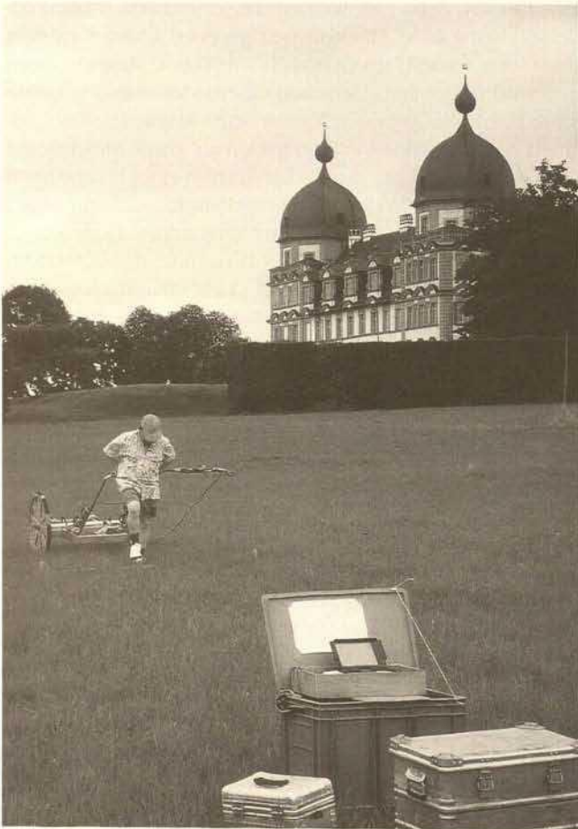
Abb. 3, Meßapparatur für die Magnetometerprospektion: Der Geräteaufbau zeigt den unmagnetischen Holzwagen mit dem Magnetometer. Über ein Kabel ist die Meßsonde mit der Stromversorgung und einem Computer zur Datenaufzeichnung verbunden.
