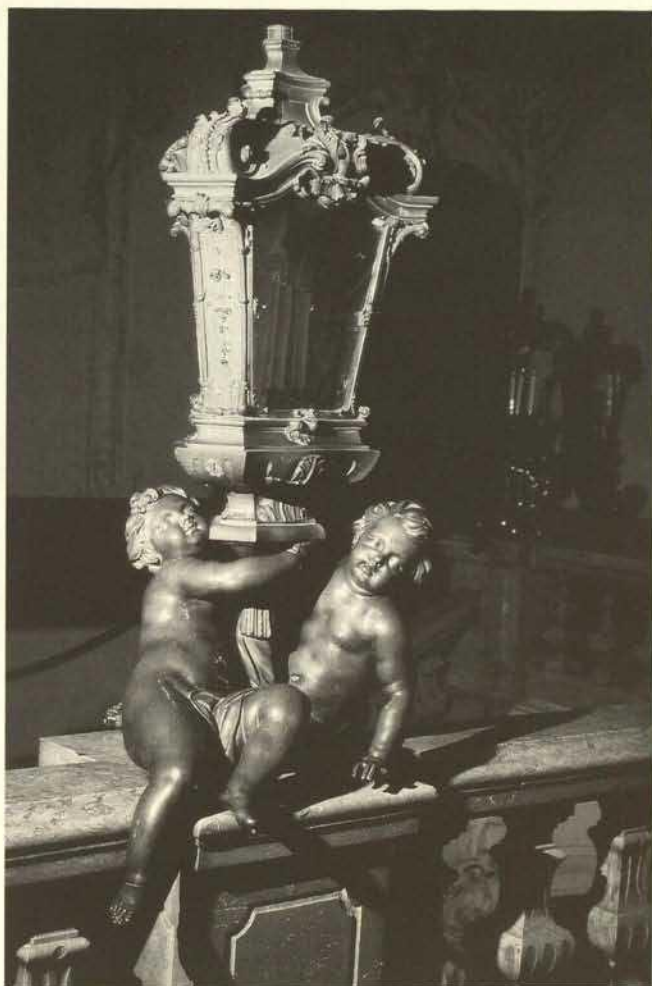
Abb. 1. Passau, Neue Bischöfliche Residenz (1768), Leuchter im Treppenhaus; Blei-Zinnguß, hervorragend erhaltene Metalloberfläche ohne beeinträchtigende Korrosionserscheinungen; Höhe des Leuchters ca. 1,50 m
