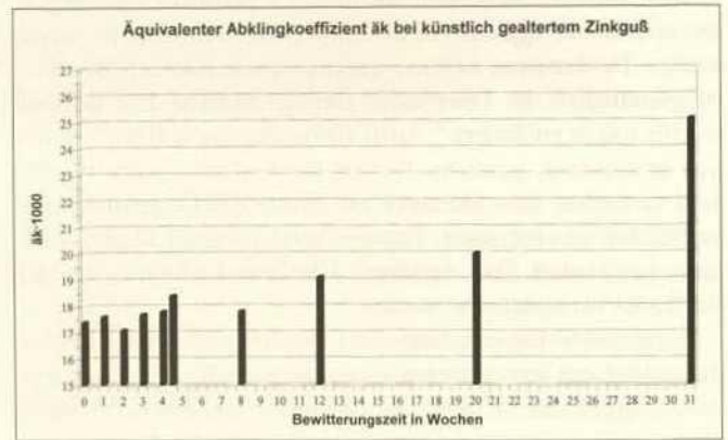
Abb. 10. Diagramm Ergebnisse Impulsrelaxationsspektroskopie: äquivalenter Abklingkoeffizient bei künstlich gealterten Zinkproben unterschiedlichen Bewitterungs- und Schadenszustands
