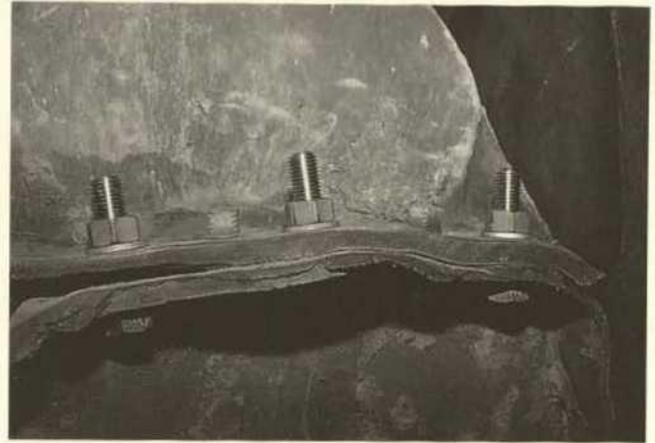
Abb. 6. Montage von Teilformen mit originalen Messingschrauben; Ersatz der durchgerosteten Eisenschrauben durch korrosionsbeständige Titanverschraubungen
