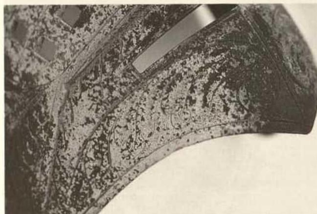
Abb. 7. Augsburg, Hl. Georg; Korrosion der Ziselierung am Visier
