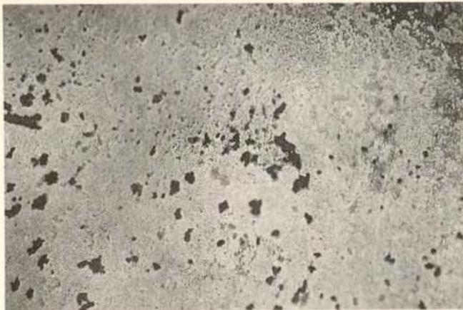
Abb. 6. Augsburg, Augustusbrunnen; Inselbildung der korrodierten Bronzoberfläche
