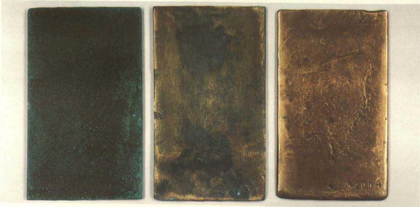
4. Gegossene Bronzeplatten nach beschleunigter Bewitterung (336 h): unbeschichtet (links), mit einlagiger ORMOCER-Beschichtung OR 1 (Mitte), und mit zweilagigem ORMOCER-Schutzsystem OR 16 (rechts)
