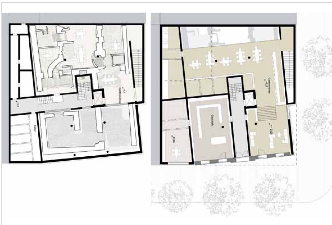
5 „Einfassung“: Untergeschoss und Erdgeschoss mit historischer Bauflucht. DMSW.
