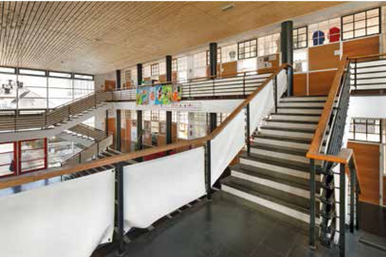
Abb. 4: Die Aula und die anschließenden Klassen bilden einen Brandabschnitt.
