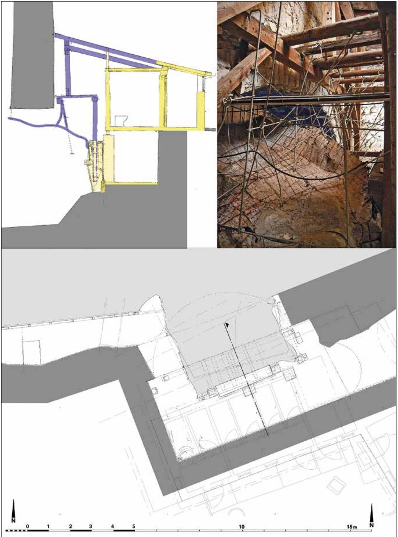
Abb. 17: Seebeleuchtungsbogen und Einfahrtsöffnung mit angeschlossenem Vorraum, Grundriss und Schnitt, Baualtersplan
