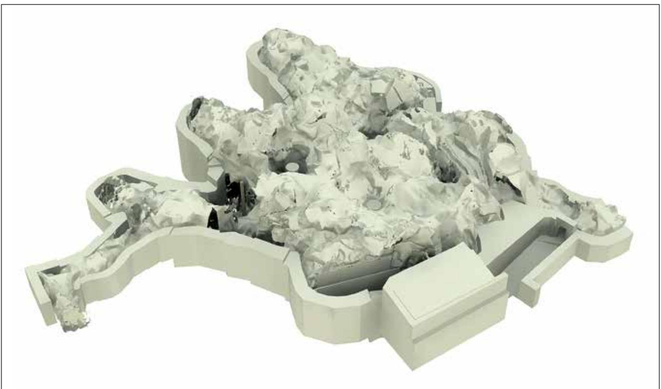
Abb. 2: Modell der Grotte mit Außenmauern und Drahtputzschale
