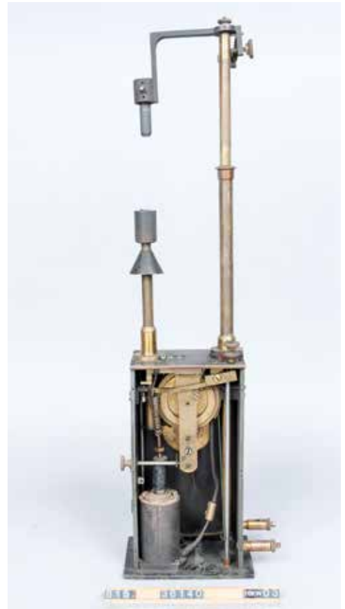
Abb. 4: Bogenlampe, System Schuckert (Inv.-Nr. 36140)
