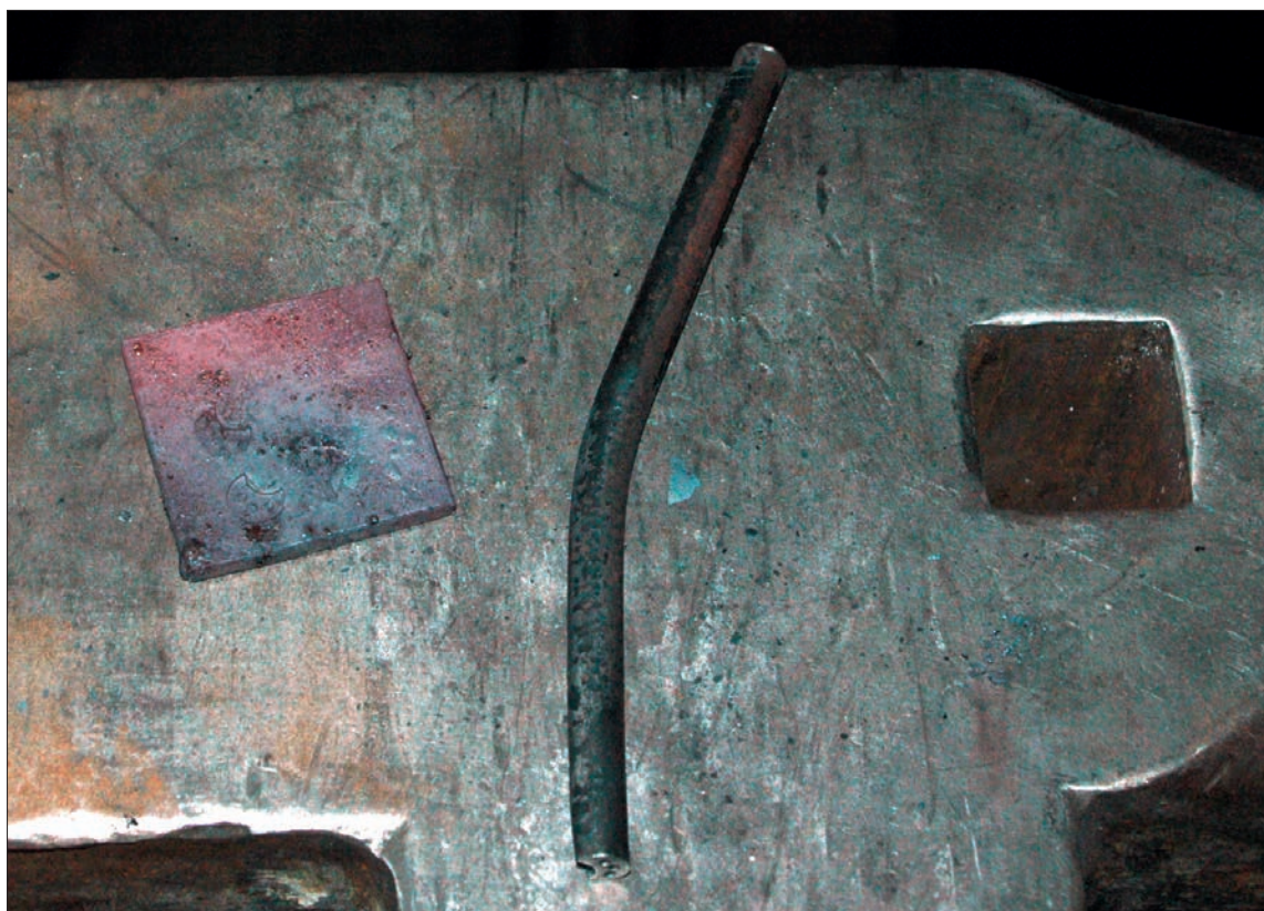
Abb. 23 Experiment 2: a gestempelte Stahlplättchen. – b Verbiegung des Stempels. – (Fotos L. Deutscher).
