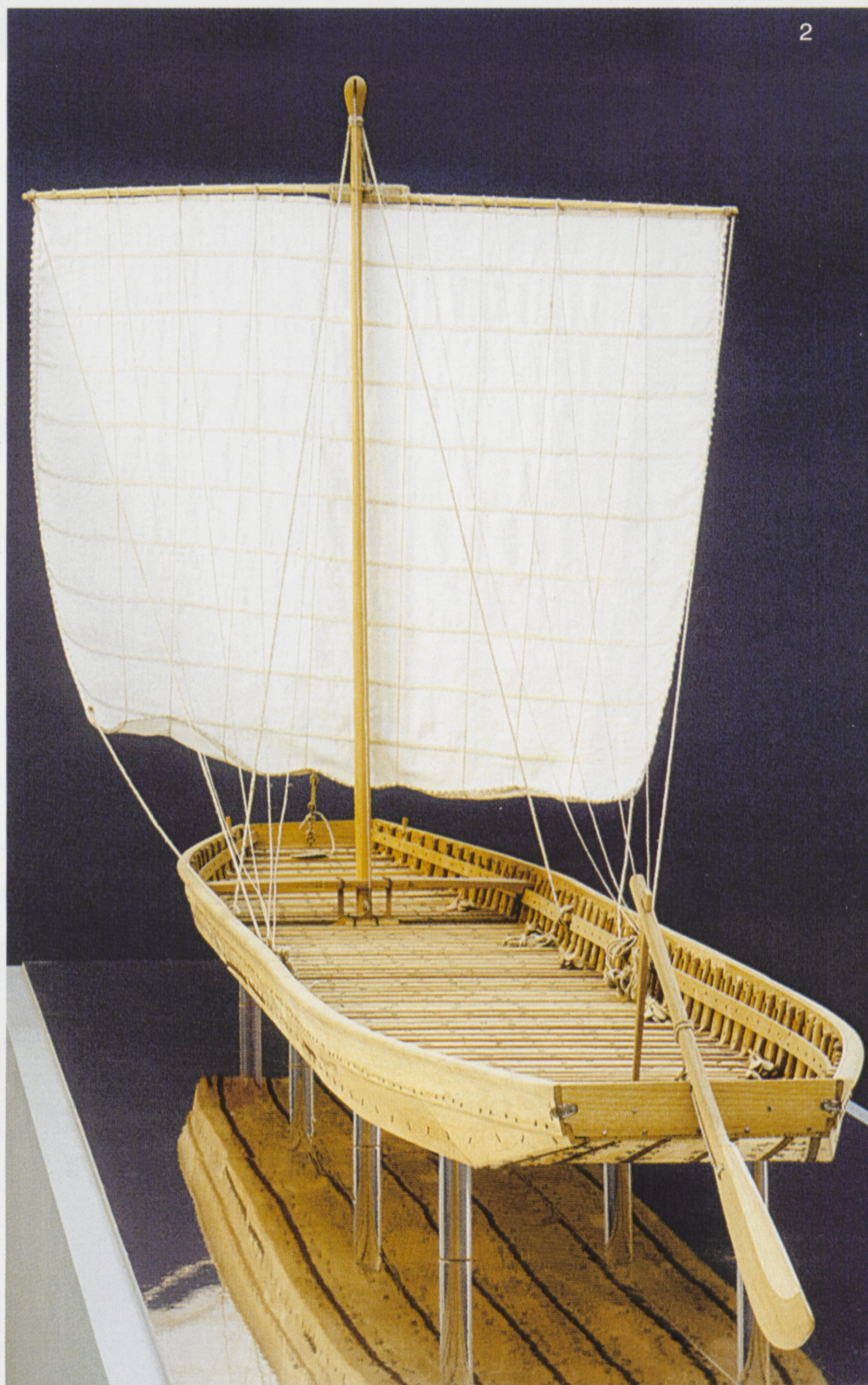
Mainz, Prahm 1. Modellrekonstruktion im Museum für Antike Schifffahrt, Mainz. – 1 Seitenansicht von Backbord. – 2 Heckansicht. – 3 Heck mit ergänzter Ruderanlage. – 4 Vordere Mittelsektion mit ergänzter Mastverankerung (verriegelbares Mastspant und mehrteiliger Mastducht).
