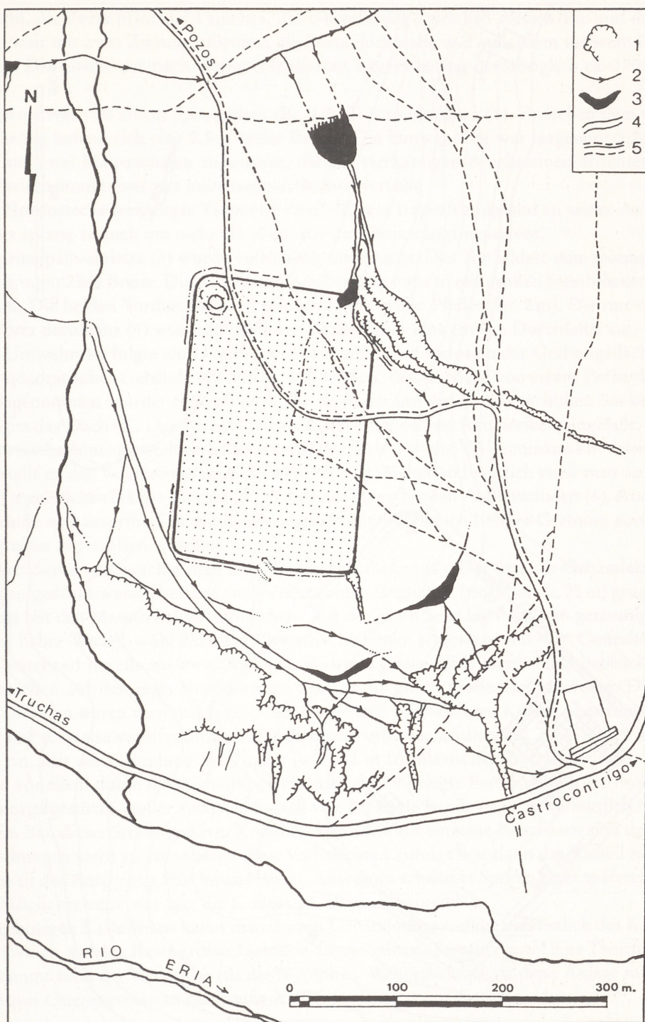
Abb. 36 Valdemeda, Plan des Lagers. – 1 Spuren vom Tagebau. – 2 Wasserkanäle. – 3 Wasserbecken – 4 Straße. – 5 Wege und Pfade. – M = 1:5000.
