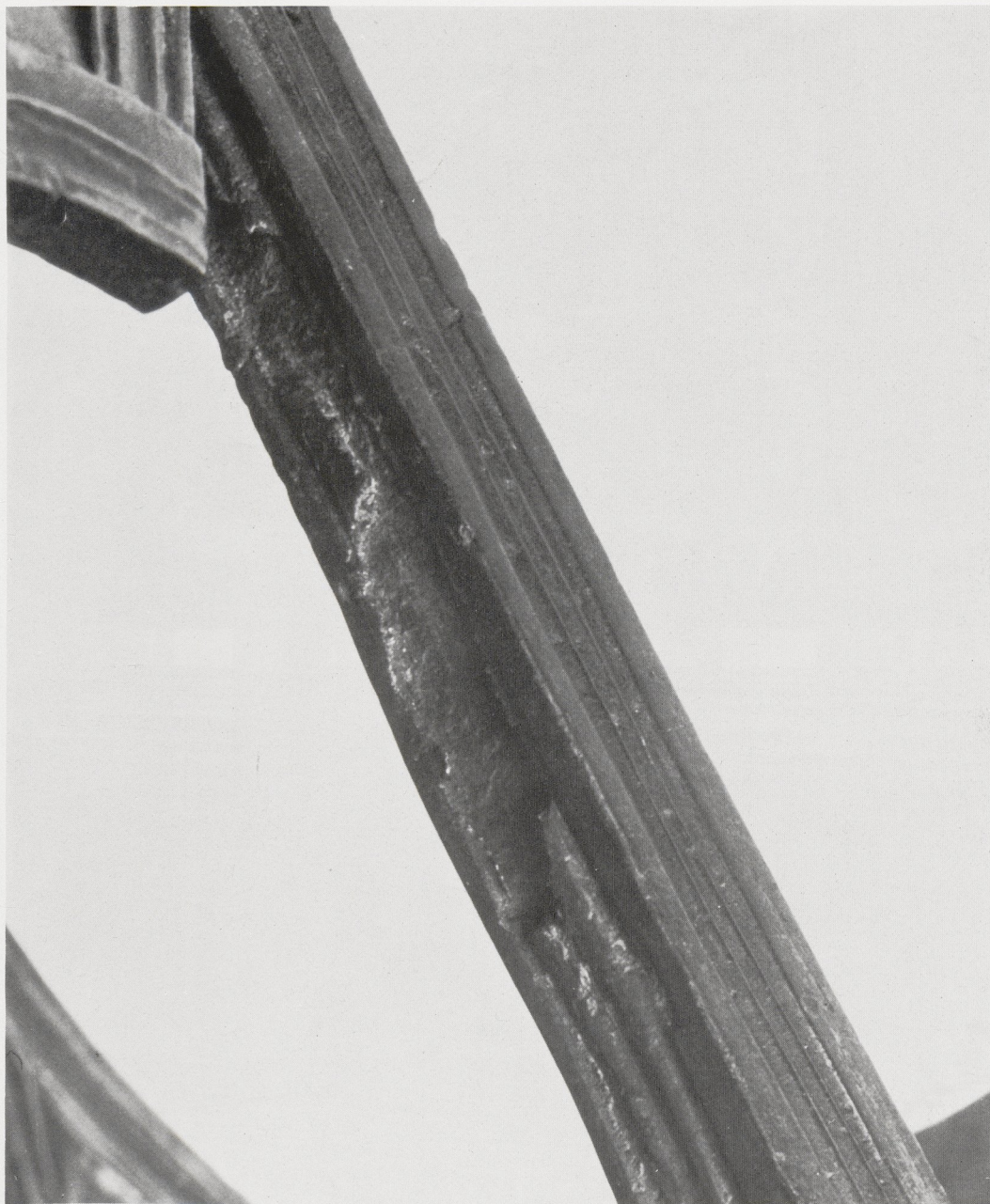
Dagobert-Thron, hintere von links oben nach rechts unten verlaufende Querstrebe (Stadium 3) mit fehlerhaftem Bronzeguß über Eisenkern.
