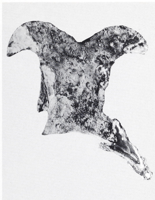
2 Scheitelkamm vor der Restaurierung, teils angeschliffen. Kupfer-(I)-Oxid- und Chloridschichten.
