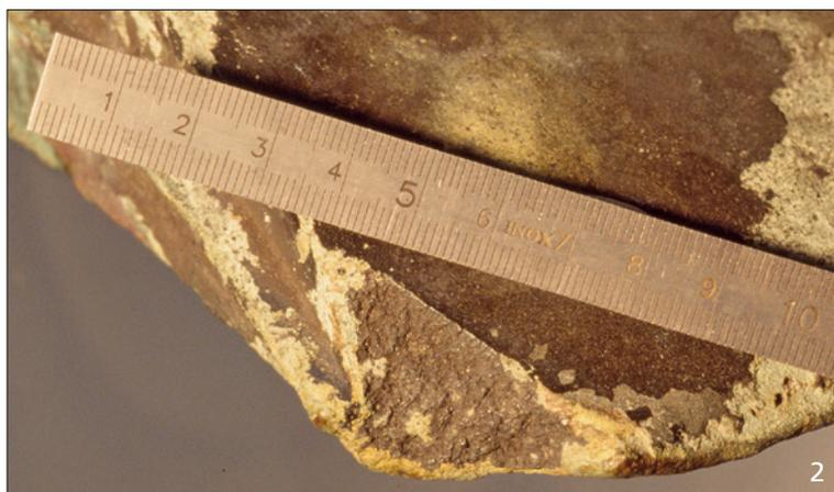
**Abb. 24** Bremerhaven-Rammsporn. Antike Ausbesserung und Beschädigung: **1** Reparatur auf der Oberseite der oberen Finne beim Rammkopf, seitlich der Nase, an Backbord. – **2** abgebrochene Ecke der unteren Finne, an Steuerbord. – (Fotos R. Bockius).
