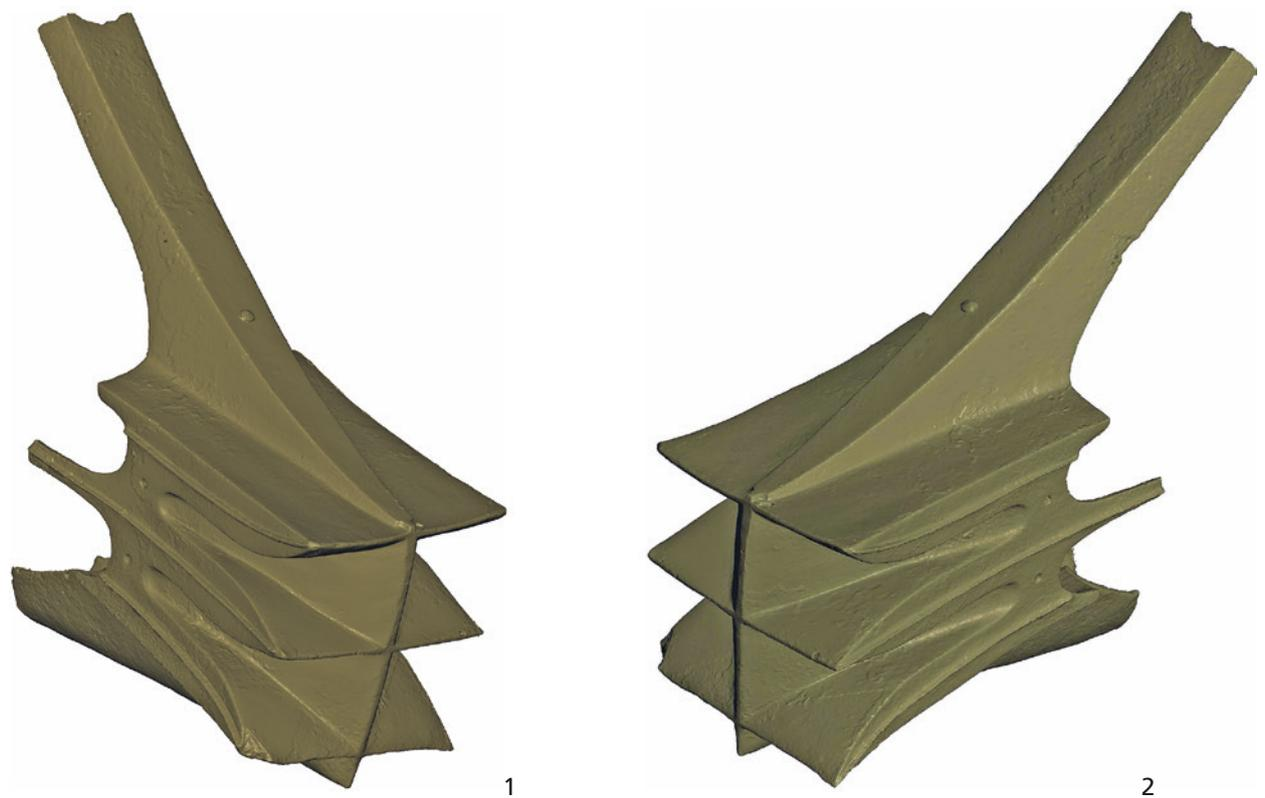
**Abb. 35** Bremerhaven-Rammsporn. Oberflächenmodell auf der Basis von Messungen mit einem Streifenlichtscanner ATOS II, Fabrikat GOM. Messvolumen 800 mm/600 mm/600 mm bei 0,6 mm Punktabstand. – **1-2** perspektivische Ansichten. – (Aufnahme und Datenaufbereitung im Rahmen einer Kooperation zwischen dem RGZM und dem i3mainz der Hochschule Mainz im April 2008 durch G. Heinz, RGZM).
