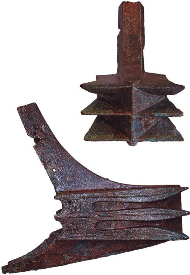
**Abb. 1** Gewässer um Levanzo, Ägadische Inseln, Sizilien (prov. Trapani/I). Bronzener Rammsporn eines antiken Kriegsschiffes: Egadi 1. – (Nach Tusa 2011, 225 Abb.).
