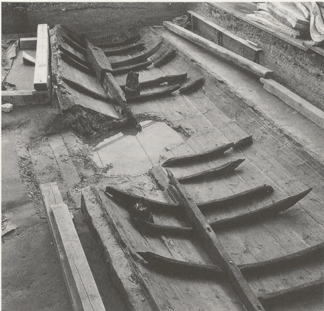
Abb. 16 Oberstimm, Bayern. – Blick in den Mitschiffbereich von Schiff 2. Deutlich zu erkennen ist das Kielschwein mit den in regelmäßigen Abständen eingetieften Aussparungen für die Ruderbankstützen. Im vorderen Schiffsbereich ist das Kielschwein stark verdickt. An dieser Stelle stand einst der Mast.
