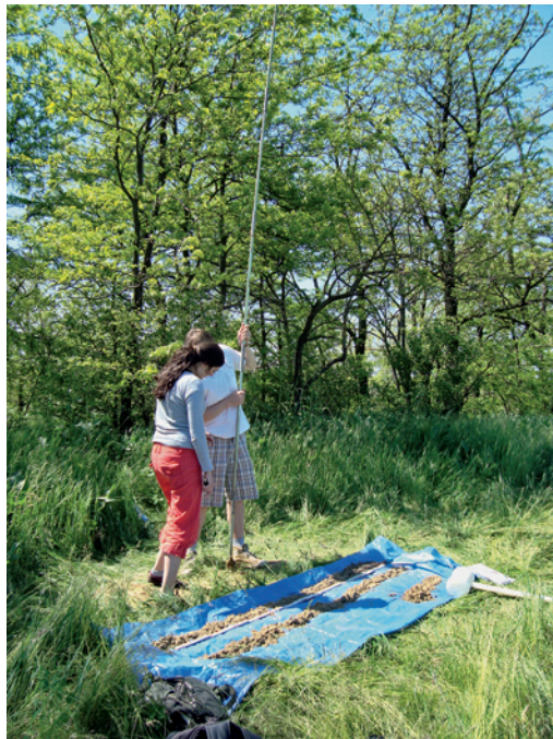
Bohrungen auf einer Düne mit dem Ziel, begrabene Paläoböden zu erfassen.
