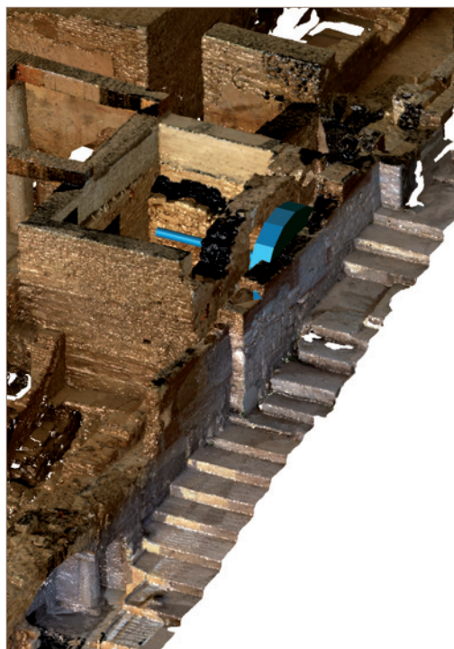
Schnittansicht der Werkstatt B16 mit zugehörigem Wasserradgerinne.
