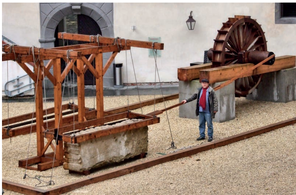
Funktionsmodell der Steinsäge von Ephesos mit Wasserrad im Maßstab 1:1 im Innenhof der Schallaburg.
