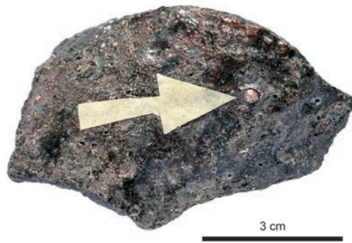
Gusstiegelfragment mit anhaftendem Metalltropfen.
