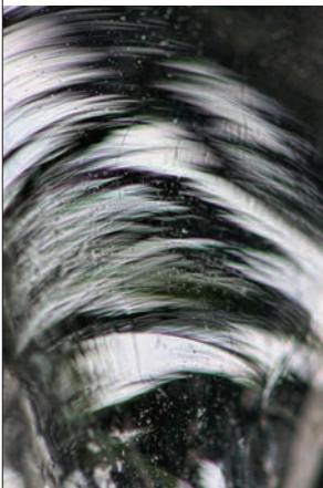
Kreuzende Wallner-Linien auf der Bruchoberfläche einer gebrochenen Spitze.
