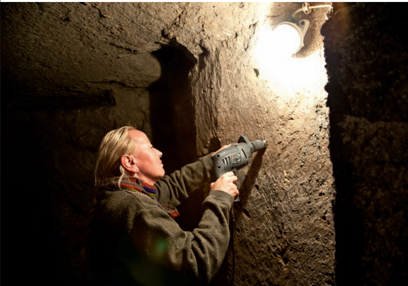
Antiker Tuffstollen in der Hochstraße 51 in Kruft. Jutta Geisweid und Benjamin Streubel entnehmen Proben zur mineralogischen Untersuchung.
