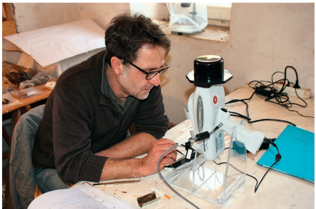
Einsatz der mobilen RFA-Anlage zur Analyse der Metallreste aus der Buntmetallwerkstatt.
