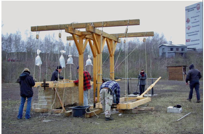
Nachbau der byzantinischen Steinsägemaschine aus Hanghaus 2 in Ephesos.
