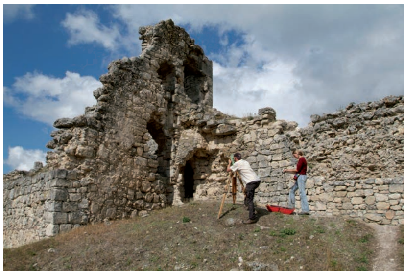
Mangup, Zitadelle: Vermessungsarbeiten für die photogrammetrische Aufnahme der Ruine und Ansicht der steingerechten Auswertung.
