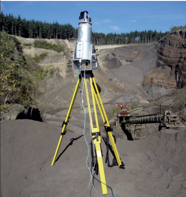
Vermessungsarbeiten mit einem 3-D-Laser-scanner am Eppelsberg bei Nickenich in der Osteifel.
