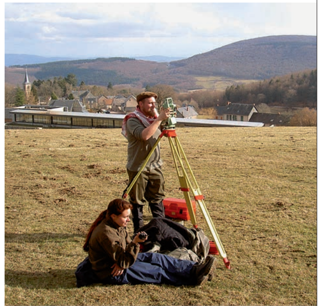
Glux-en-Glenne (Nièvre): Kartierung von Maulwurfshäufen durch Studierende der Universität Mainz auf einer Wiese im Umfeld des Mont Beuvray mit Totalstation und Funkgerät zur Übermittlung von Fundnummern.
