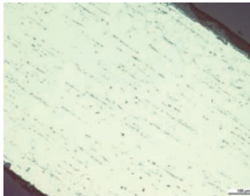
Parallel angestreckt Einschlüsse (Auflicht, 10 Fach Optik, Bildbreite 100 \mu\text{m} ).
