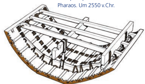
Gizeh, Ägypten. Isometrischer Querschnitt der im Pyramidenbezirk des Cheops deponierten Totenbarke des Pharaos. Um 2550 v. Chr.
