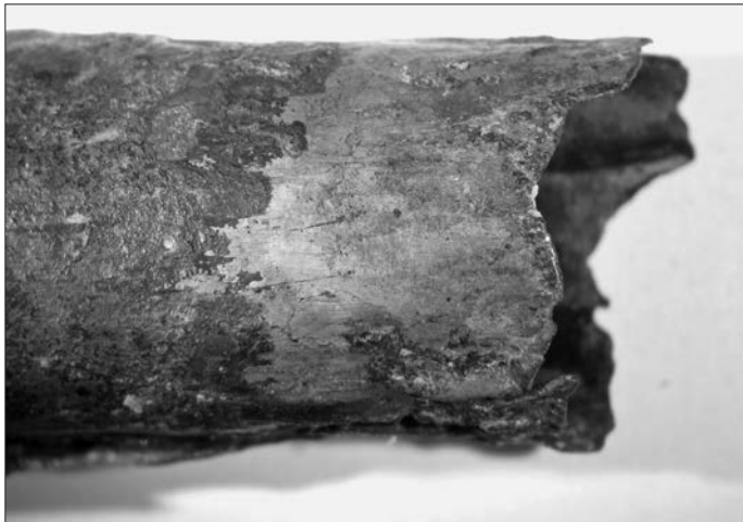
Abb. 3 Die graue Metallbeschichtung (hier Bauteil F) erwies sich als Lot und stellt nicht wie ursprünglich vermutet eine Verzinnung dar (untere Bildkante = 3,3 cm).
