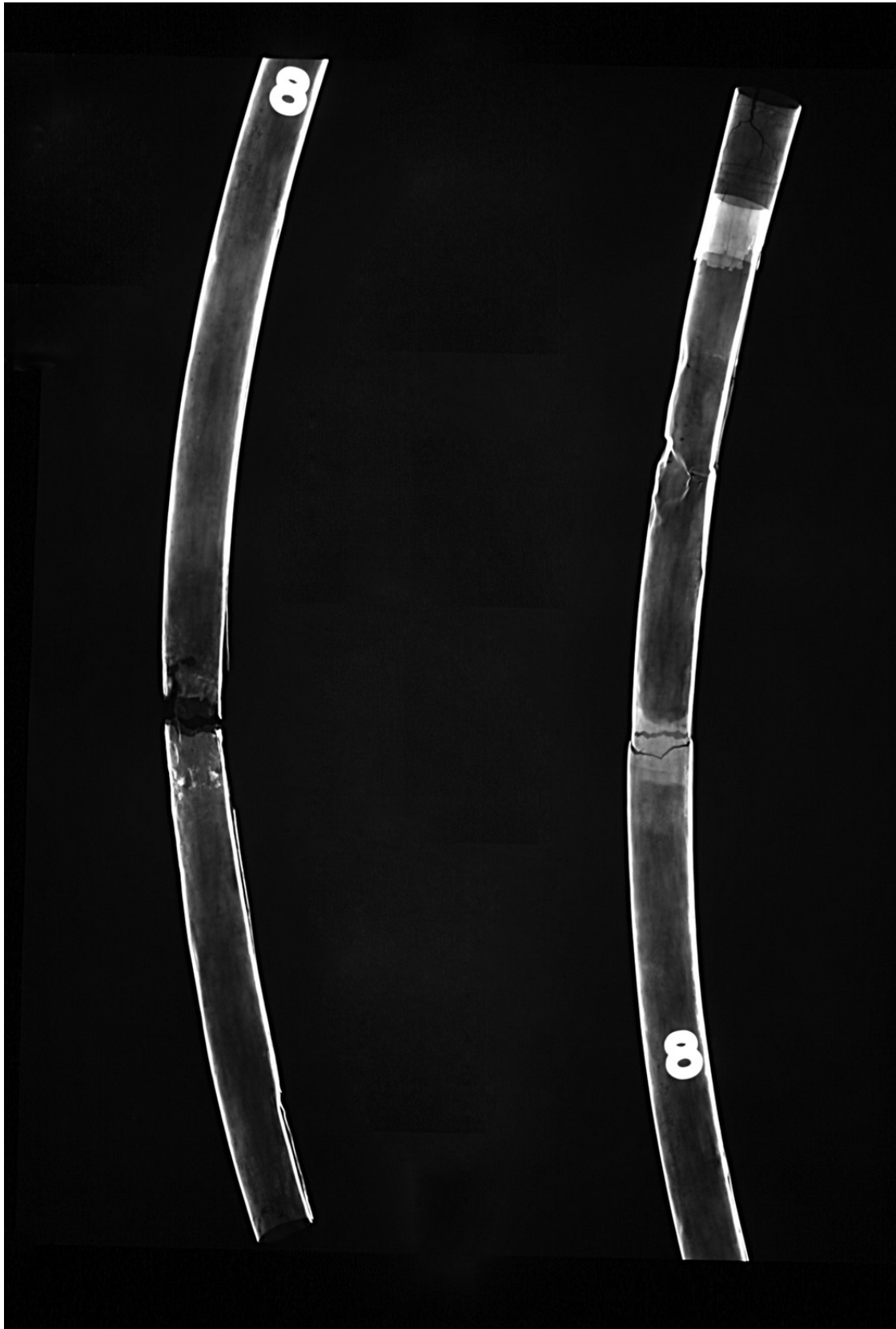
Taf. 7 Cornu im Privatbesitz: Teile E/Nr. 5 und F/Nr. 4, Röntgenaufnahmen.
