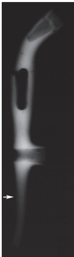
Abb. 8 Röntgenaufnahme des Stangenknebel Kat.-Nr. 42. Der Pfeil markiert die feinen Risse, die durch die Verkrümmung des unteren Teils hervorgerufen worden sein dürften. – (Foto M. Paysan, Landesmuseum Württemberg). – M. 1:1.
