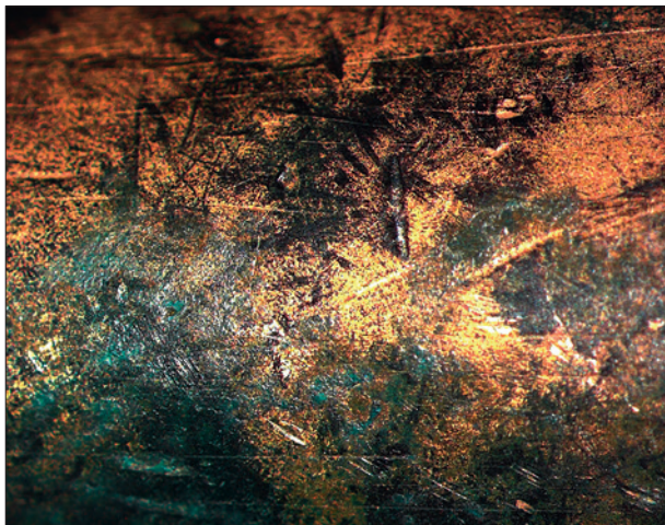
Abb. 7 Binokularaufnahme (20-fache Vergrößerung) der Oberfläche des Lanzenschuhs Kat.-Nr. 16. Deutlich sichtbar sind die zahlreichen, sich vielfach kreuzenden Striemen. Wahrscheinlich handelt es sich um Gebrauchsspuren, die z.B. durch das Einrammen des Lanzenschuhs in den Boden entstanden sein könnten. – (Foto C. Pankau).
