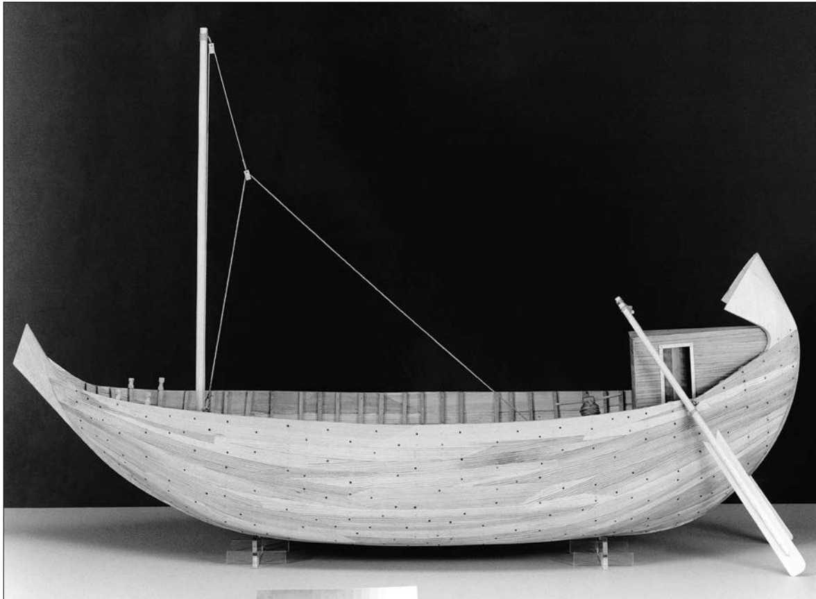
Abb. 19 Rekonstruktion eines römischen Seeleichters nach dem Wrack Fiumicino 1 und dem Grabfresko von der Porta Laurentina in Ostia.
