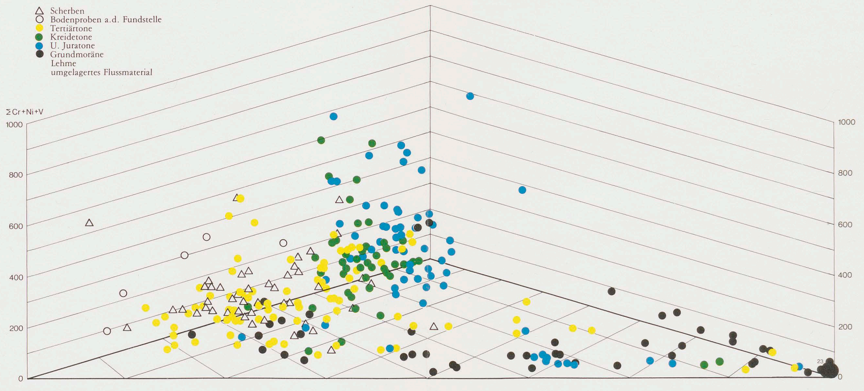
Darstellung der Analysenergebnisse im räumlichen Modell. — Höhenlage der Punkte über dem Dreieck Cr (Chrom) — Ni (Nickel) — V (Vanadium) ist proportional der Summe der Cr-, Ni- und V-Gehalte.
