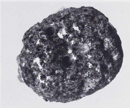
4 Eigener Herstellungsversuch. Perlen wegen Zusatz von zuviel Soda zerschmolzen. — M = 3:2.
