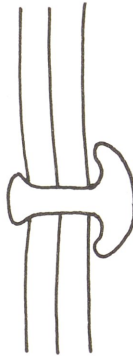
Abb. 2 Kesselwandung mit Niet.
