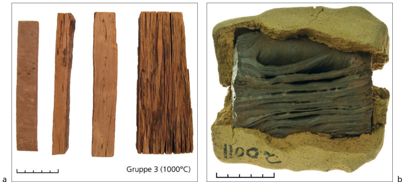
Abb. 4 Bei 1000°C blättert der Testriegel aus Schiefer auf (a). Eine Lehmummantelung des Schiefers wurde bei 1100°C aufgesprengt (b). – (a Foto E. Hanning; b Foto B. Streubel, RGZM).
