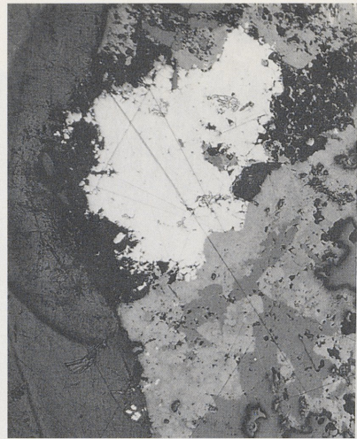
1-2 Çatal Hüyük, Grab E. VI. 29: 1 Proben von Bleiperlen. – 2 Polierter Anschliff einer der Bleiperlen. Die helle Phase ist eindeutig als Bleiglanz zu identifizieren, wie u. a. an den dreieckigen Ausbrüchen festzustellen ist. Die dunkleren Phasen bestehen aus Anglesit ( \text{PbSO}_4 ), Cerussit ( \text{PbCO}_3 ) und Schwerspat ( \text{BaSO}_4 ).
