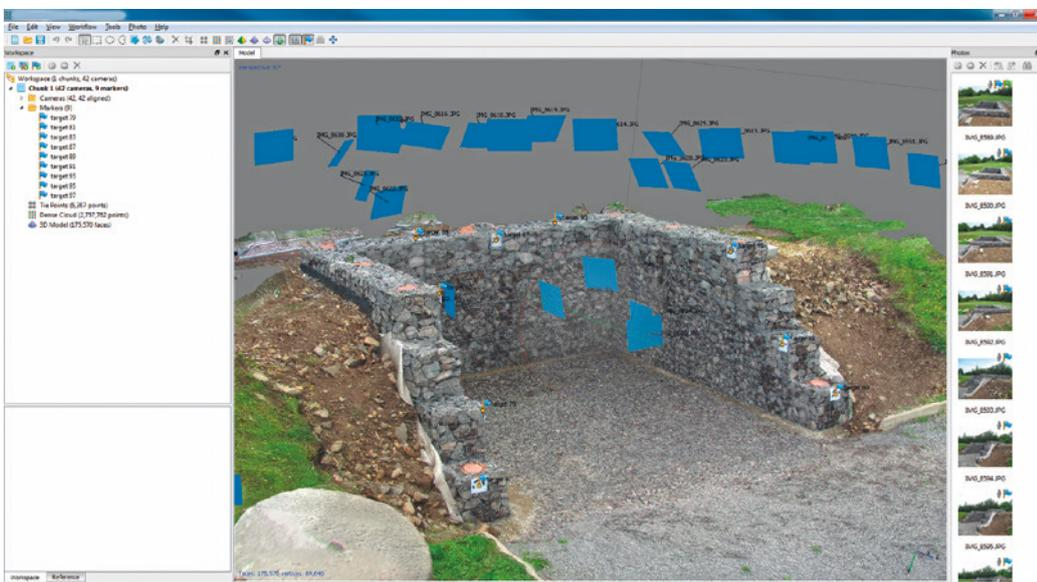
Dokumentation der Situation vor Baubeginn des Gabionenwerks. Die Abbildung zeigt das virtuelle Modell, die verwendeten Bilder und die Aufnahmepositionen.
