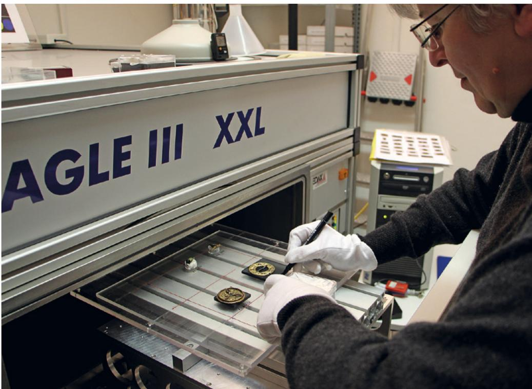
Vor der Röntgenfluoreszenzanalyse werden die Objekte vorsichtig auf einem beschrifteten Träger im Gerät montiert.
