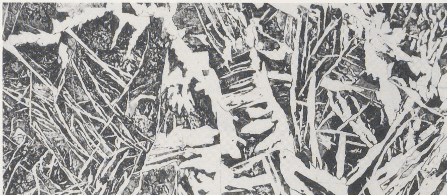
Abb. 4 1 Ausgangsgefüge des C15-Stahls. – 2 Entkohlter Bereich des Stahls aus Bild 1 nach dem Glühen in der Erdkuhle. 3 Aufgekohlter Bereich des Stahls aus Bild 1 nach dem Glühen in der Erdkuhle.
