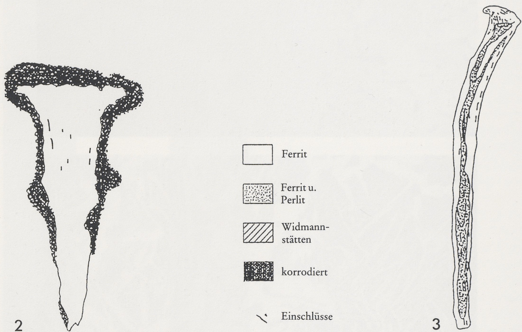
Abb. 5 1 Kohlenstoffverteilung über den Querschnitt bei verschiedenen Nägeln. – 2.3 Schematische Verteilung der Gefügeelemente: 2 in Nagel 2 aus Schiff 9; 3 in Nagel 4 aus Schiff 1.
