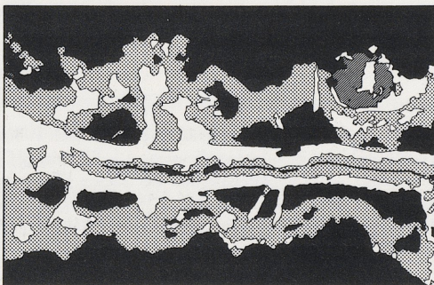
Abb. 3 Dünnschliffaufnahme des Eisenerzes Fnr. 2571. Dünnschliffaufnahme des kompakten Hämatiterzes (dunkler Bereich), das von einer \text{CaCO}_3 -Phase (helle Gangart) und einer mangan-eisenreichen Karbonatphase (gelbe Bereiche) verdrängt ist. Der dunkelgraue Kristall ist ein Quarz, der in einer ebenfalls sekundären Phase ausgebildet wurde. – Vergr.: 110x; Pol. X.
