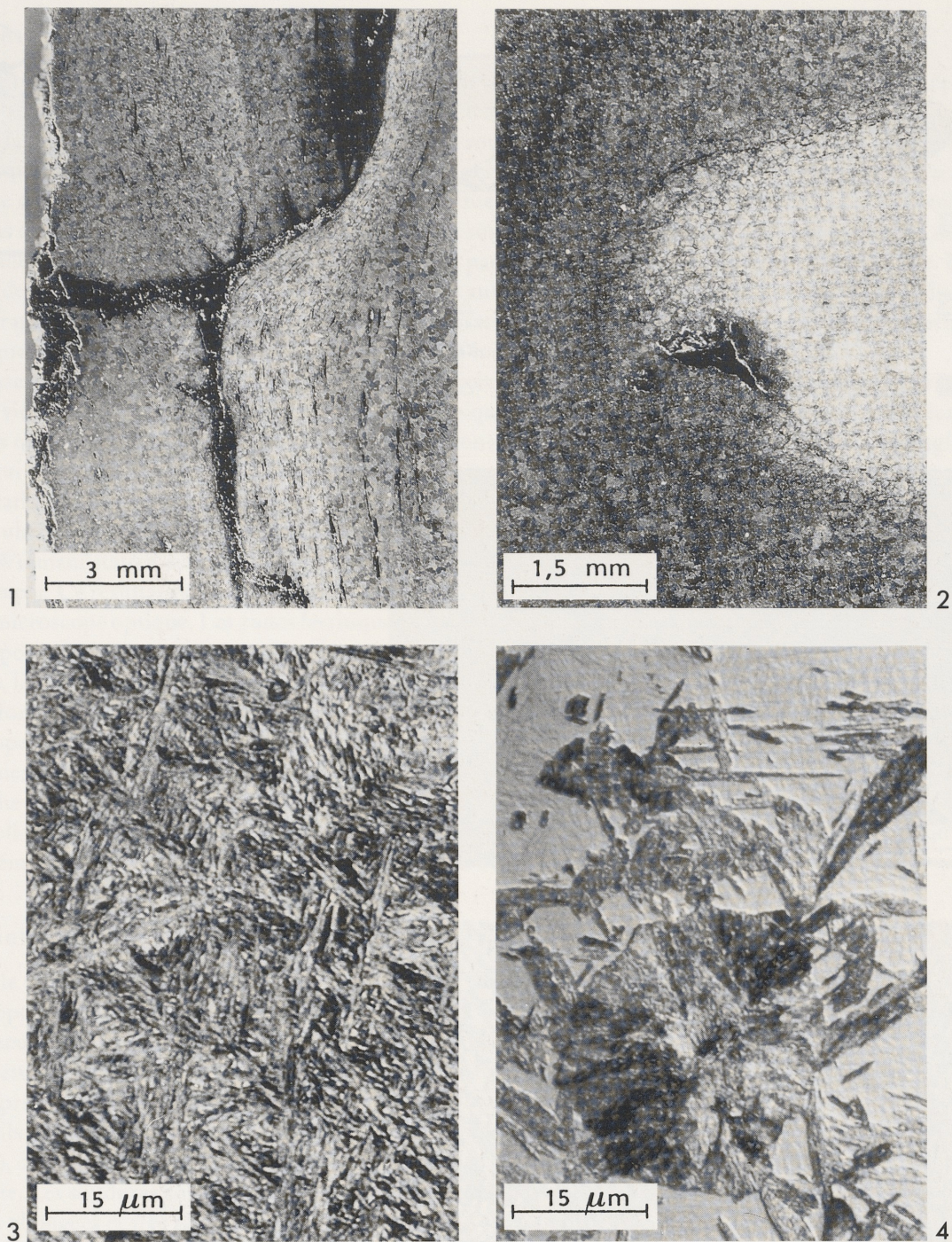
Fig. 6 1 Fissures au niveau de la tête de la pointerolle. – 2 Soudure de l'insert. – 3 Martensite. – 4 Perlite nodulaire dans un environnement bainito-martensitique.
