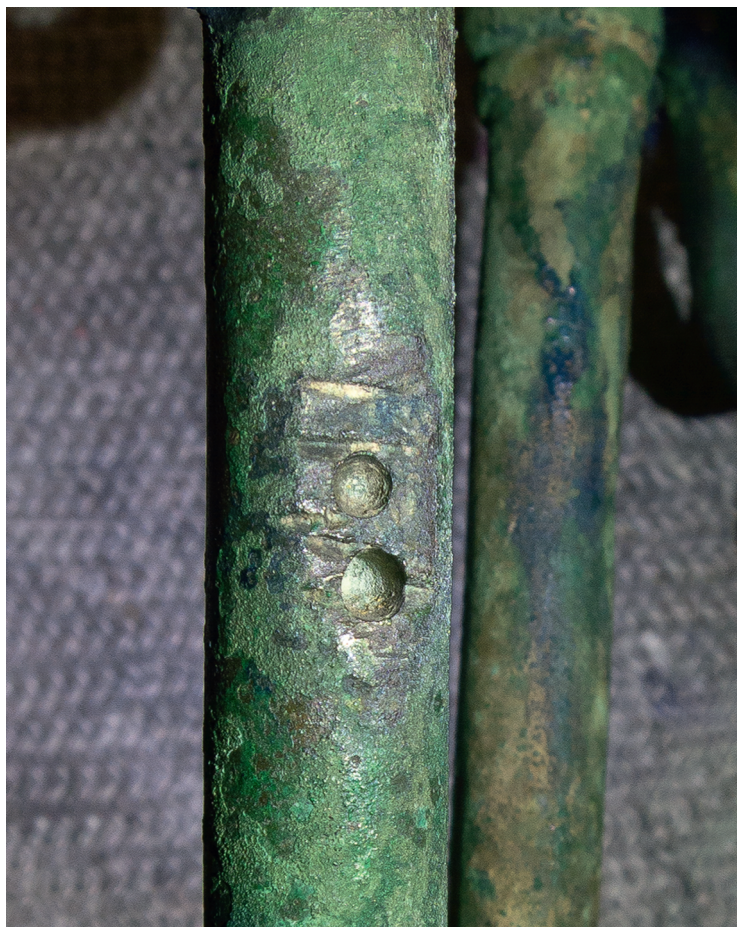
17 Dübellöcher mit Weichlot im Bogenfeldstab von Seite 5 an der Ansatzstelle für die rechte Zwickelschlange unter der Bogenfeldleiste
