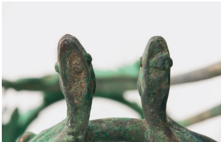
13 Ansätze von Gusskanälen (Anschnitte) unter den Schlangenköpfen am unteren Ring von Seite 3
