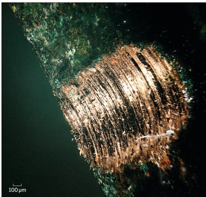
Abb. 8 Thale, Lkr. Harz. Keule. Die Probebohrung verdeutlicht den Farbunterschied zwischen der dunkelgrünen Patina und der darunter liegenden Bronzelegierung.
