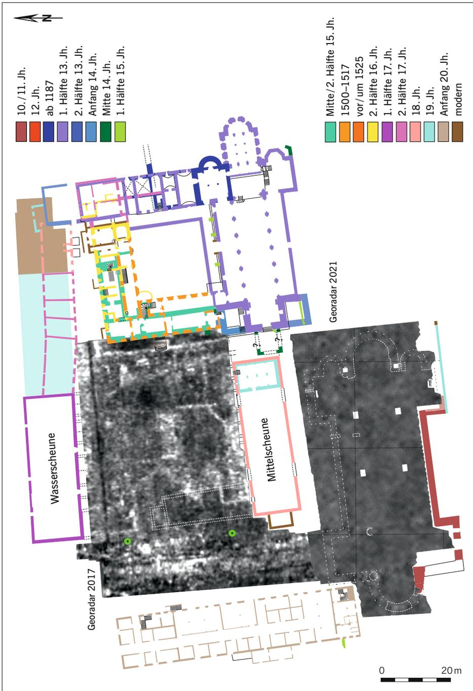
Abb. 1 Kloster Memleben. Übersicht zum Gebäudebestand mit vorläufig unterschiedenen Bauphasen und GPR-Vermessungsarealen 2017 und 2021.
