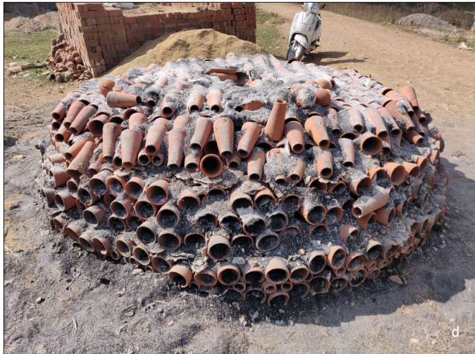
Abb. 40d–e Bilaspur, Chhattisgarh (Indien). d Abgebrannter und ausgekühlter Feldbrandofen während der Entnahme der gebrannten Guntubes; e platzsparendes Stapeln der neu produzierten Röhren für den Abtransport auf einem Lkw. Fotos 2017–2018.
