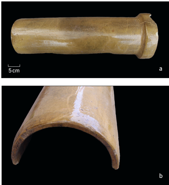
Abb. 56a–b Dessau, Muldvorstadt, Flössergasse. Keramisches Wasserrohr vor/um 1900, glasierte Irdenware. a Gesamtansicht; b Detailaufnahme des einziehenden, abgeschrägten Rohrendes.
