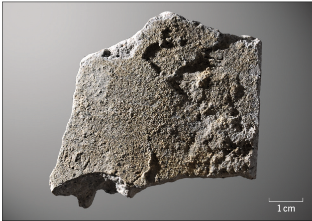
Abb. 13 Quedlinburg, Krypta St. Servatii. A 17364: Nahaufnahme von Einsatzspuren eines Körpers respektive Beckens am Gipsputz. Vorstehende, am anzunehmenden Becken anliegende Bereiche sind durch das Andrücken flach (links im Bild), tiefer liegende dagegen uneben (rechts im Bild).
