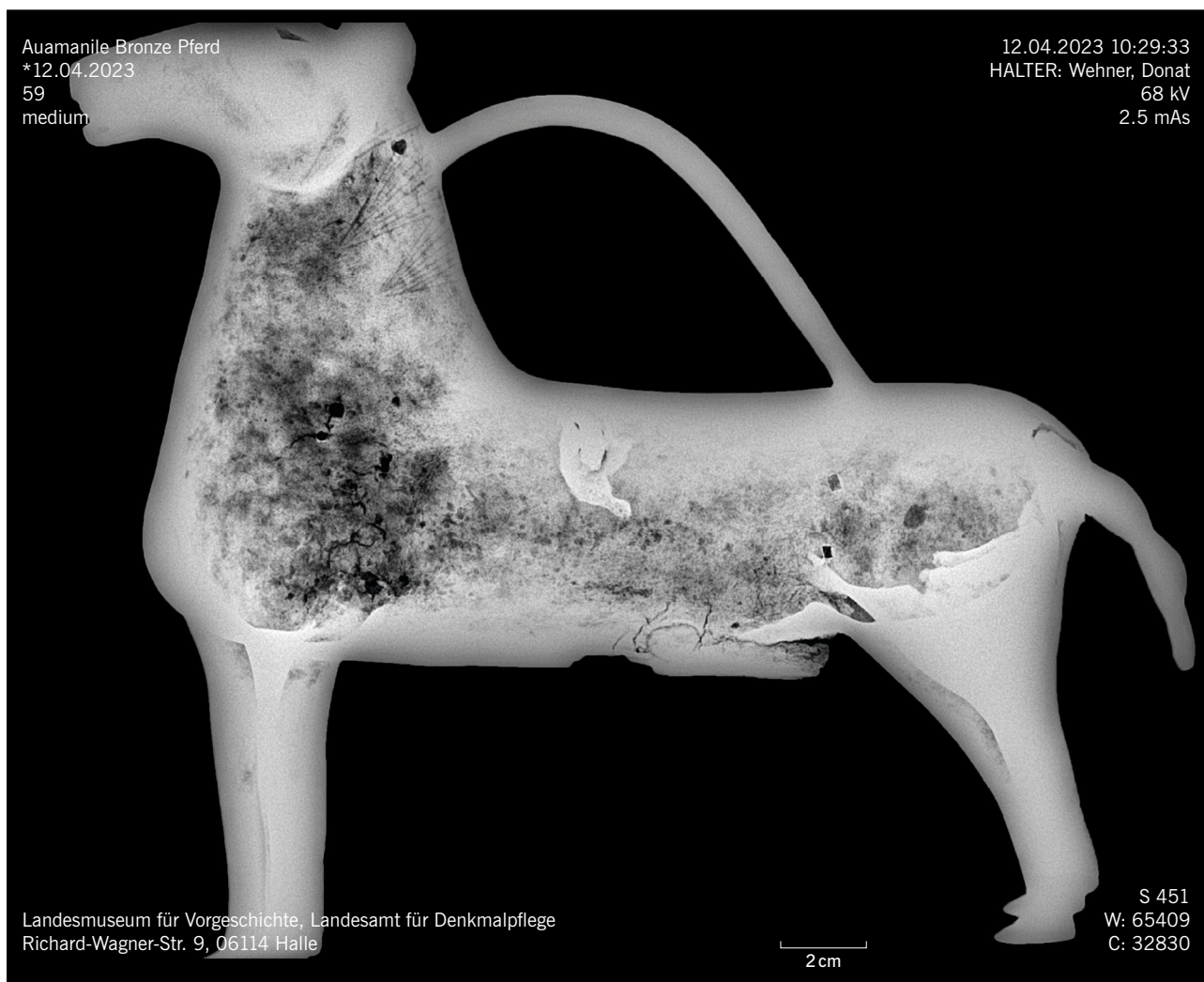
Abb. 9 Demsin. Im Röntgenbild geben sich die als Kernhalter dienenden Metallstifte deutlich zu erkennen.
