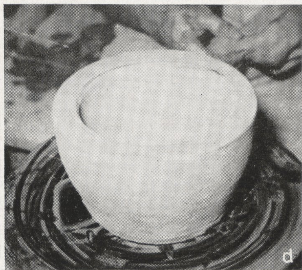
Auf der Töpferscheibe hergestellter Kugeltopf: Mit aufgewulstetem Rand (a); mit vollständig abgedrehtem Boden (b); Schnitt durch den Kugeltopf (c); Herstellung des Kugeltopfes mit Hilfe einer Form: Die Form oder Pfanne (d); der Ton wird in die Pfanne hineingedrückt (e)
