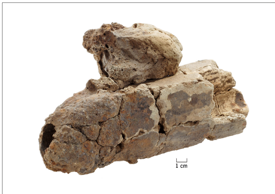
Abb. 16 Elbingerode, Lkr. Harz. Düsenziegel mit anhaftender Ofenwandung aus Befund 103 (HK-Nr. 2319-103-94).
