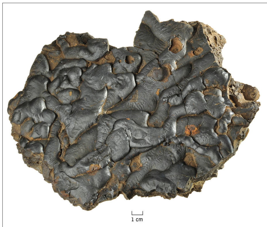
Abb. 17 Elbingerode, Lkr. Harz. Fließschlacke aus Befund 103 (HK-Nr. 2319-103-93).
