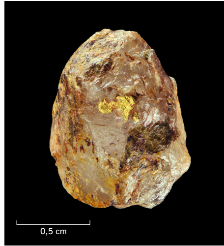
Abb. 5 Gediegenes Berggold als Einschluss in einem Fragment einer (Gold-)Quarz-Adern. Ähnliche Gold-Quarz-Adern finden sich unter anderem in Gesteinen des Grundgebirges der paläozoischen europäischen Mittelgebirge und in den Alpen.
