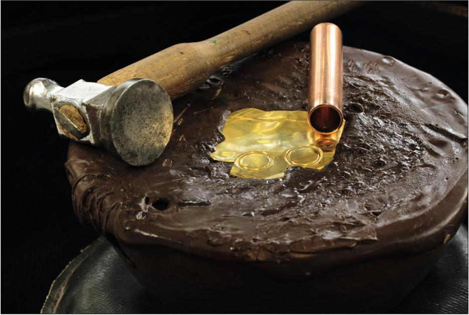
Abb. 24 Modellversuch mit Feingoldfolie. Für die ringförmige Verzierung wird ein abgesägtes und poliertes Kupferrohr verwendet.
