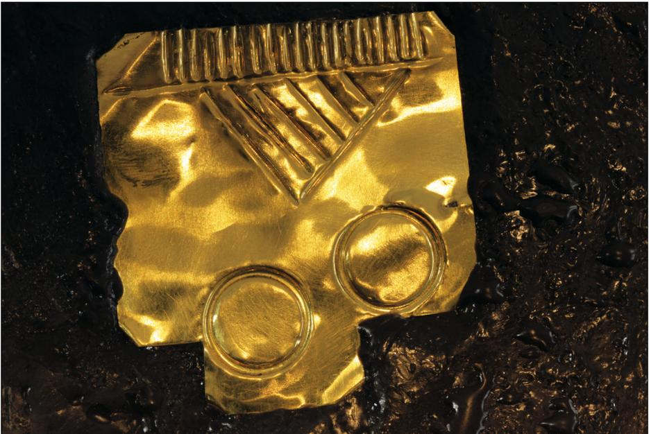
Abb. 25 Modellversuch mit Feingoldfolie. Ein treibziseliertes Blech mit Bernstorf-Motiven. Beim klassischen Treibziselieren entstehen schärfere, härtere Linien.
