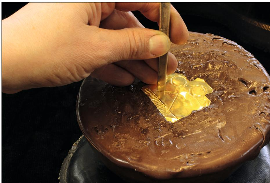
**Abb. 23** Modellversuch mit Feingoldfolie. Die strichgefüllten Dreiecke werden mit einer Schrotpunze aus Stahl ausgeführt.
