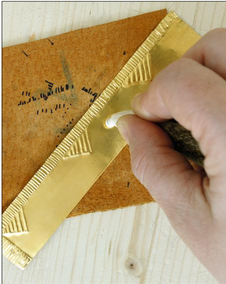
**Abb. 13** Modellversuch mit Feingoldfolie. Zum Anbringen der halbkugeligen Verzierung wird die Metallfolie umgedreht. Anschließend wird eine Kugelpunze aus Geweih in die Folienrückseite gedrückt.
