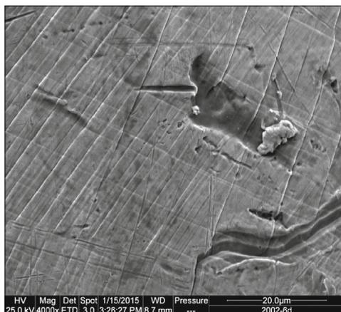
**Abb. 1** Rasterelektronenmikroskop-Aufnahme der Oberfläche eines der Goldfunde aus Bernstorf. Neben Kratzern und »Löchern« sind vor allem sich kreuzende Linien sichtbar.
