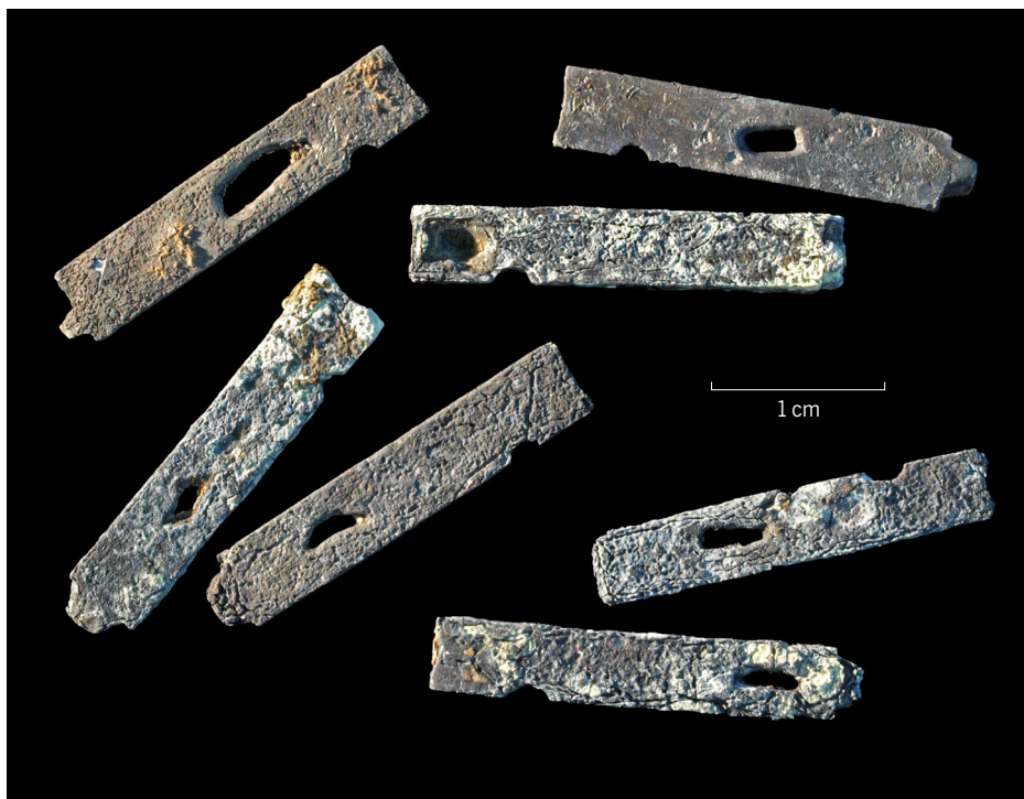
Abb. 46 Mehrere Lettern vom Arsenalplatz (Lutherstadt Wittenberg) mit durchgehenden Lunkern bzw. Gaseinschlüssen.
