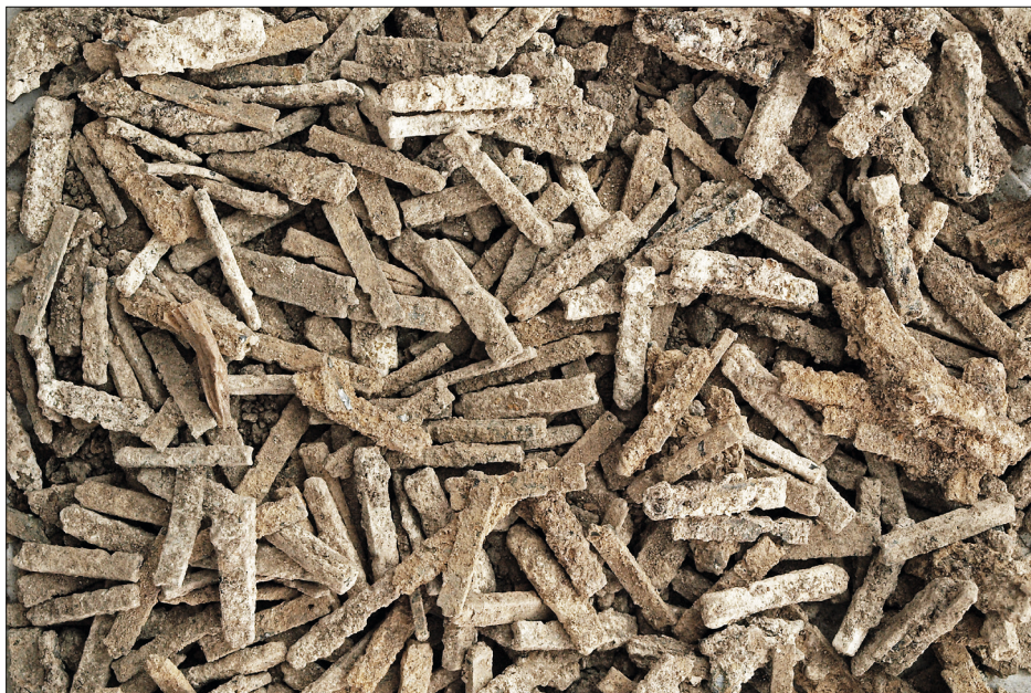
Abb. 7 Lutherstadt Wittenberg, Arsenalplatz. Ein Teil der Bleiletttern aus der Schachtverfüllung Befund 2594 im Fundzustand. Alle Lettern sind von einer dicken Korrosionsschicht aus sekundären Bleiphasen (vorwiegend Cerussit, Hydrocerussit und Pyromorphit) umgeben.
