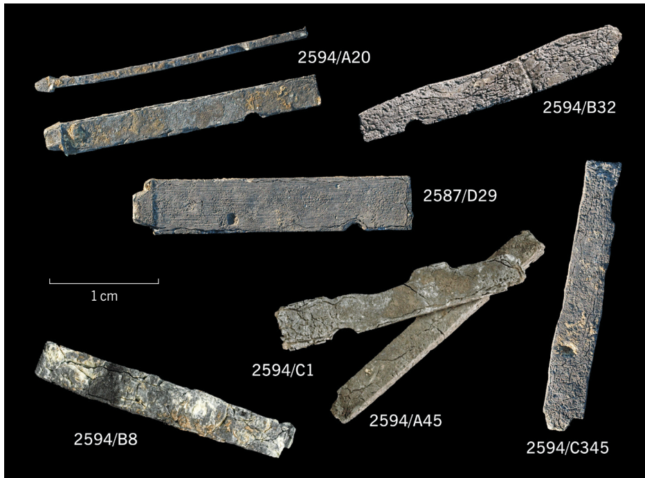
Abb. 47 Bleiletern vom Arsenalplatz (Lutherstadt Wittenberg) mit unterschiedlichen Fehlbildungen. Bei einigen fällt der Kopf breiter aus als der Kegel, andere weisen Gussgrate auf, sind deformiert oder unvollständig abgegrissen. Alle Typen dürften wohl kaum zum Druck geeignet gewesen sein.
